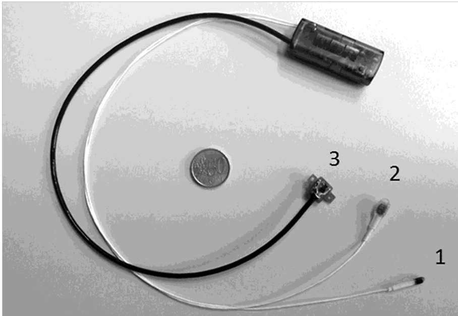
Abbildung 1. Der Datenlogger MSR145 von der Firma MSR Electronics GmbH mit einer 50 Cent Münze. 1- Temperatursensor, 2- Feuchte- und Temperatursensor, 3- Beschleunigungssensor.
